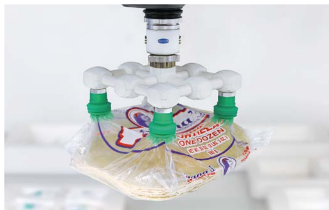
Sistema di presa con ventose a soffietto SPB4f per la movimentazione di confezioni in sacchetti con forte formazione di grinze e basso grado di riempimento
