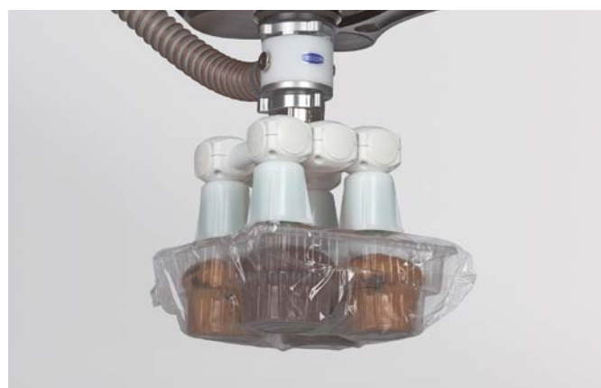
Sistema di presa con ventose a soffietto SPB4 ed elementi di stabilizzazione per la movimentazione di imballaggi labili flowwrap
