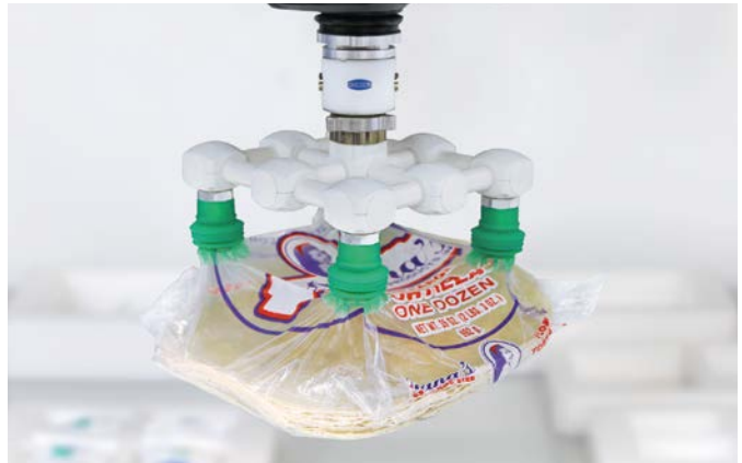
Efector final de vacío con ventosas de fuelle SPB4f durante la manipulación de envases de plástico con elevada formación de pliegues y bajo nivel de llenado
